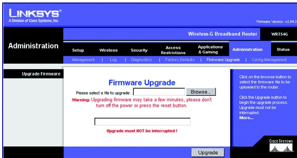
Figura 2: Acceso a actualizar el Firmware, localice y cargue el archivo binario.
