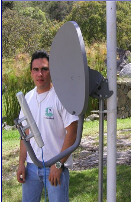
Figura 10: Enrutador inalámbrico Motorola Canopy con reflector parabólico para aumentar la ganancia.
